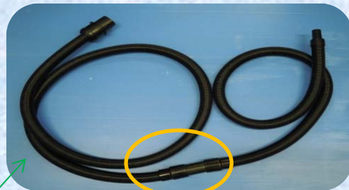
置き型用集塵機ではもともとついている5mのホースにさらに5mのホースを接続し10mに延長することができます。 (延長の際にはジョイントHが必要です。)
